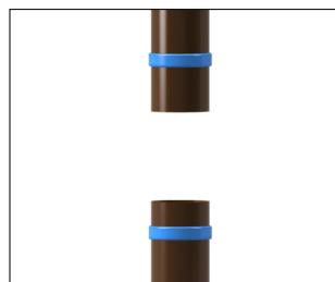
5. Установите дополнительные водосточные хомуты (не входят в комплектацию) для надежной фиксации трубы к фасаду здания
